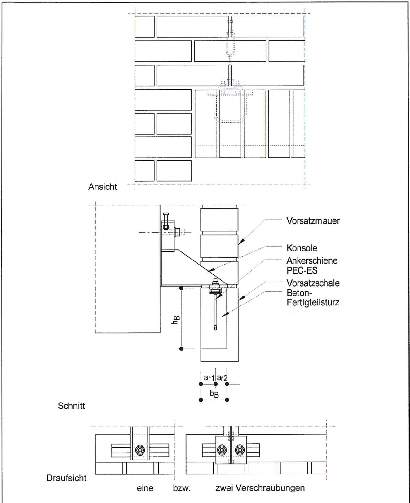
PEC-ES-Ankerschienen zur Verankerung in Fertigteilstürzen
