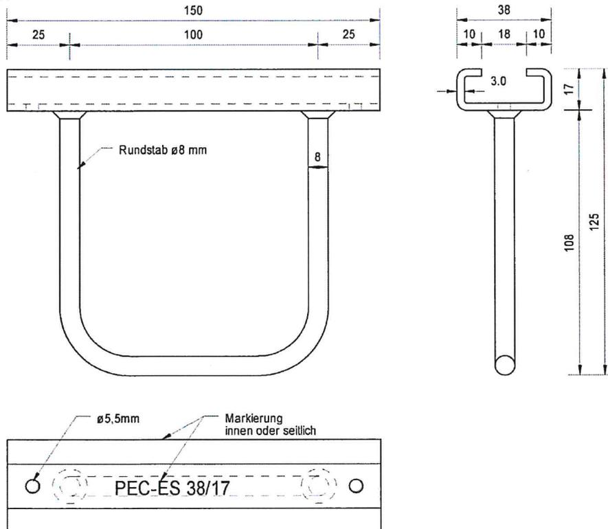
PEC-ES-Ankerschienen zur Verankerung in Fertigteilstürzen
