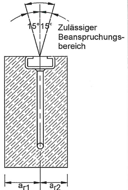
PEC-ES-Ankerschienen zur Verankerung in Fertigteilstürzen
