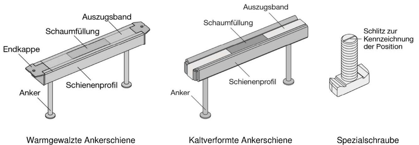
**Ankerschienen (PEC-TA) mit Spezialschrauben (HBC)**
