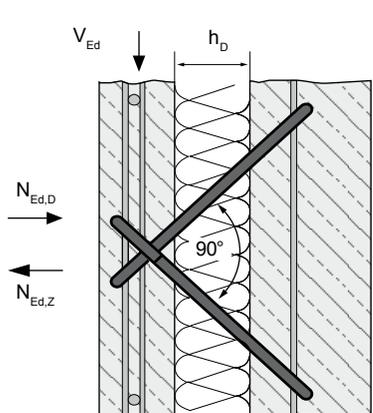
Zur Ermittlung der Tragfähigkeit müssen Ankertyp, aktuelle Horizontallasten und Dicke  $h_D$  der Dämmschicht berücksichtigt werden. Die zulässigen Abstände  $e_{max}$  sind ebenfalls von der Dicke  $h_D$  der Dämmschicht abhängig.
